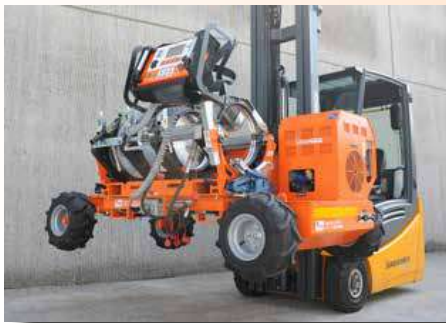
Delta 355 All Terrain levantamiento de la soldadora.
